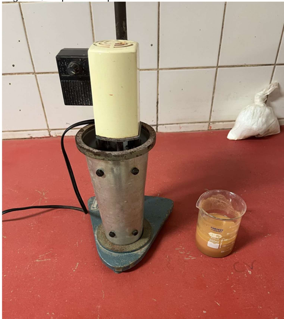
Figura 20 – Aparelho dispersor e amostra de solo com defloculante
