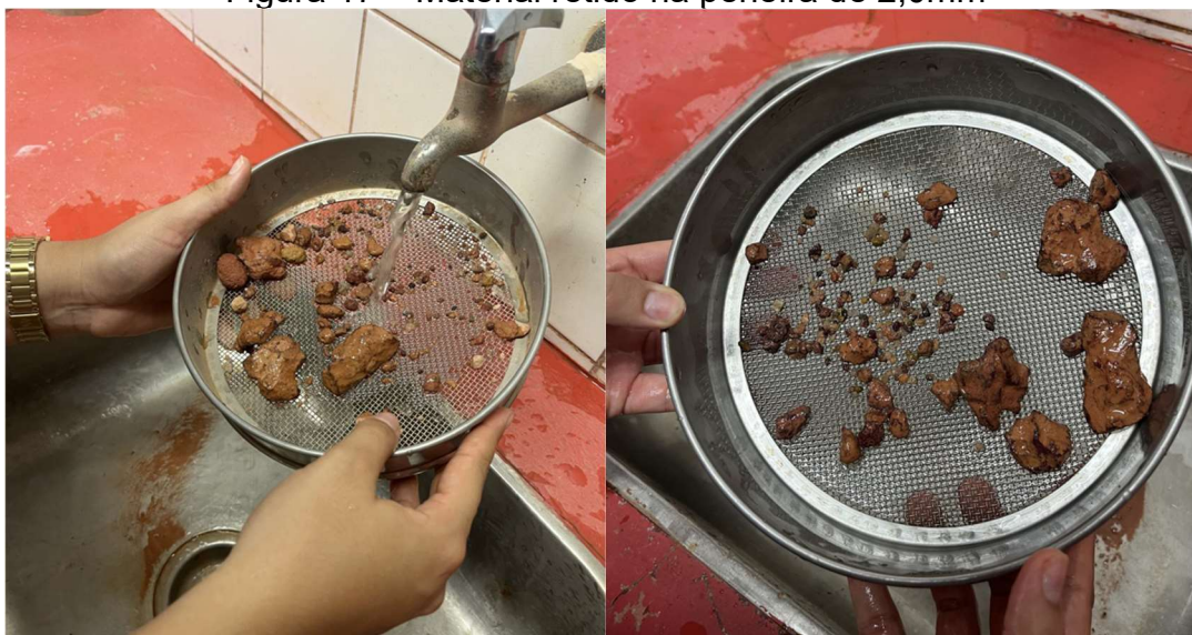
Figura 17 – Material retido na peneira de 2,0mm
