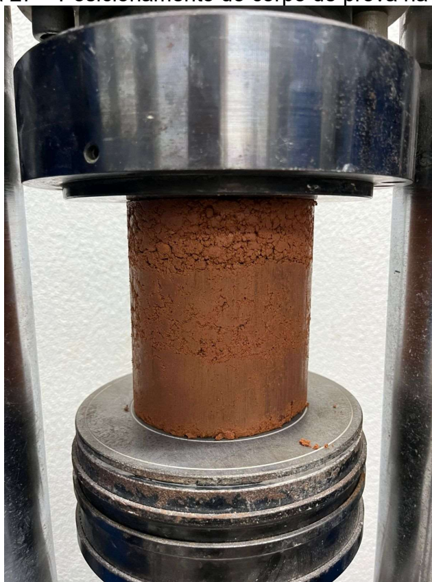
Figura 27 – Posicionamento do corpo de prova na prensa
