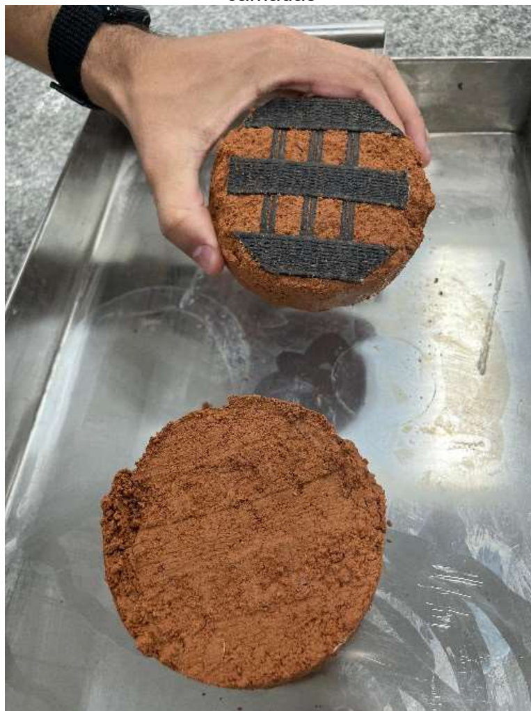
Figura 29 – Corpo de prova reforçado com geogrelha, sem aderência entre as camadas
