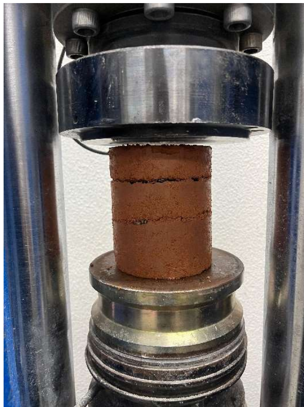
Figura 28 – Corpo de prova reforçado com geogrelha, sem aderência entre as camadas
