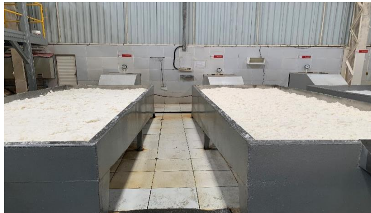
Figura 1 – forno de formulação do coco ralado úmido e adoçado.
