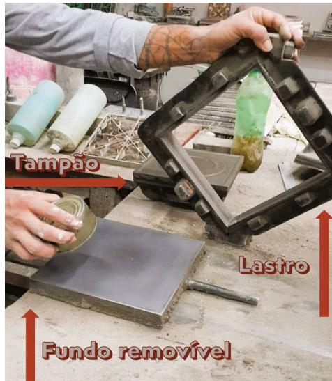
Figura 13: As três partes da forma metálica
