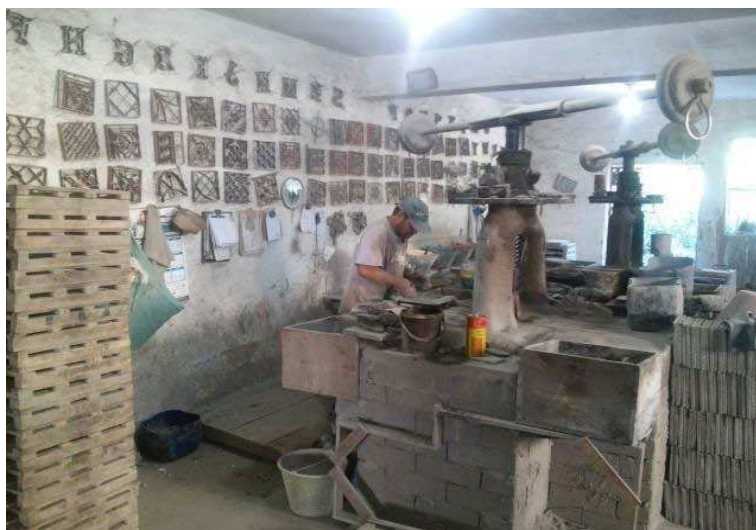
Figura 12: Ladrilheiro em ação na produção artesanal do ladrilho hidráulico
