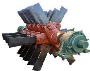
Figura 2 – O preparo da cana-de-açúcar utiliza picadores (A) e desfibradores (B) com o objetivo de aumentar a exposição das células.
