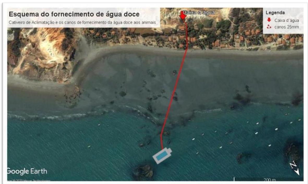
Figura 25. Esquema em vista aérea do encanamento dos olhos d'água
