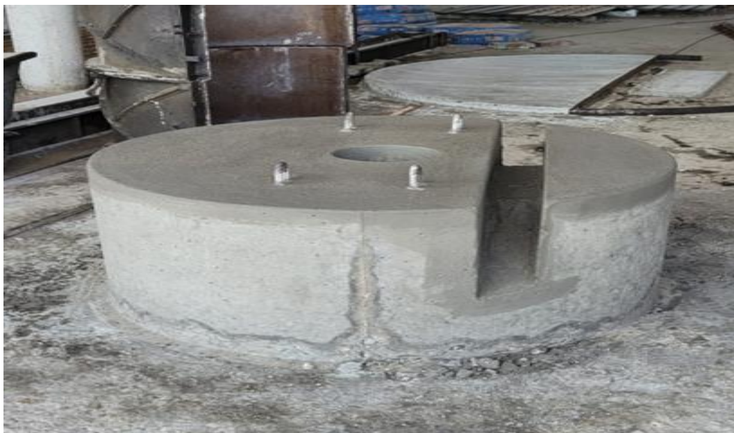
Figura 17. Poitas de concreto projetada para fixar toras de eucaliptos e rede do Cerco
