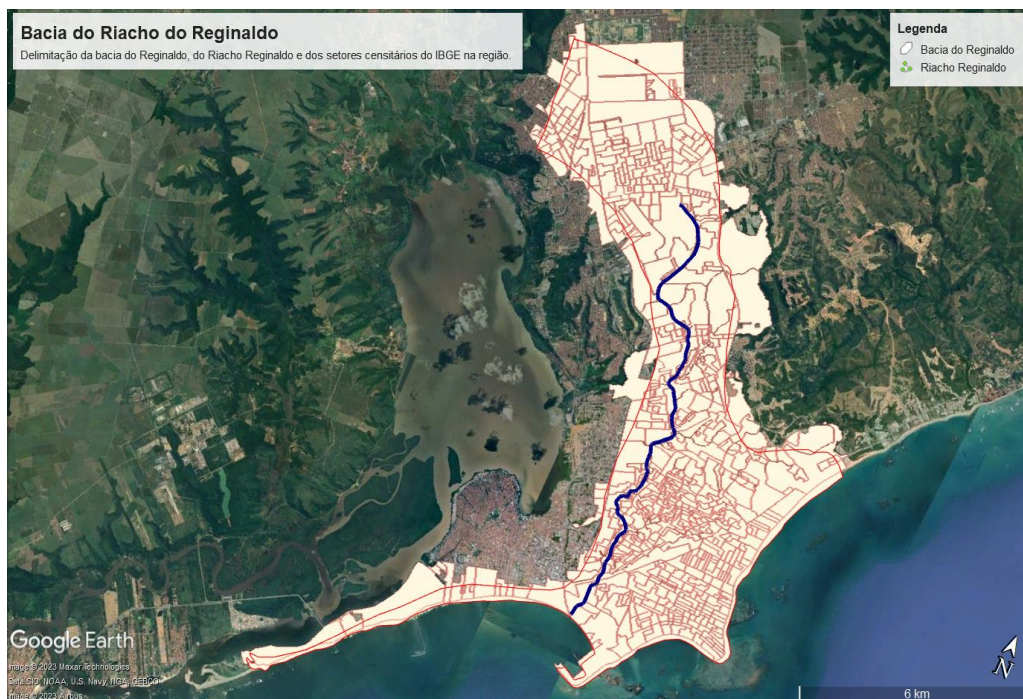
Figura 36: Bacia hidrográfica do Reginaldo, com perfil do Riacho Reginaldo em azul e malha censitária em vermelho
