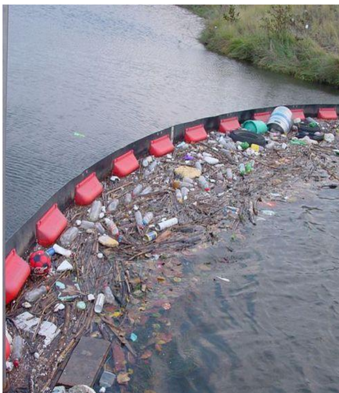
Figura 34: Exemplo de barreira de contenção de detritos no rio
