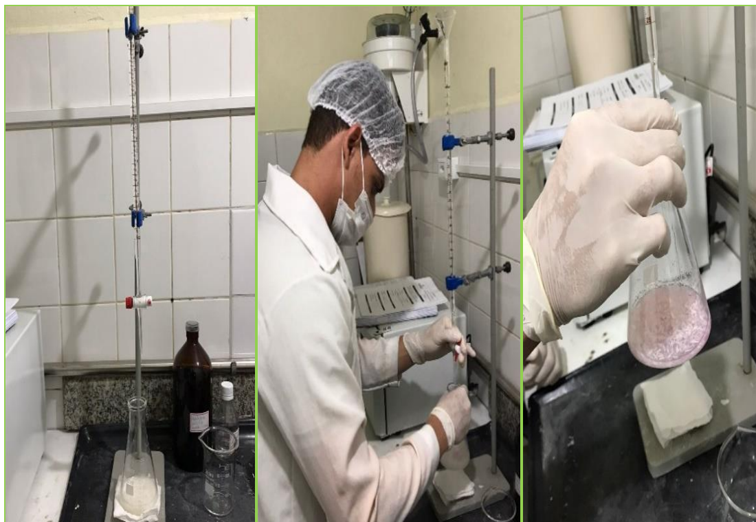
Figura 17 - Determinação de acidez titulável do coco ralado.
