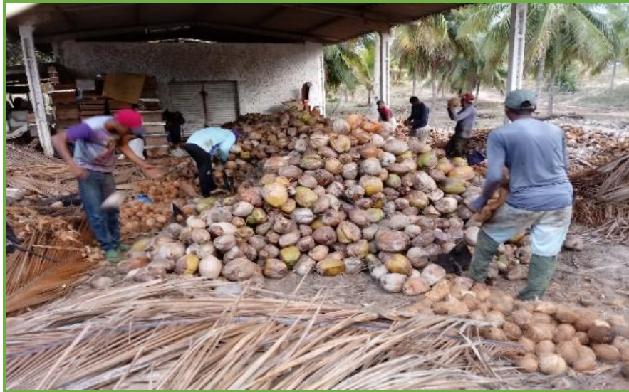
Figura 3 - Retirada do Mesocarpo e Seleção.
